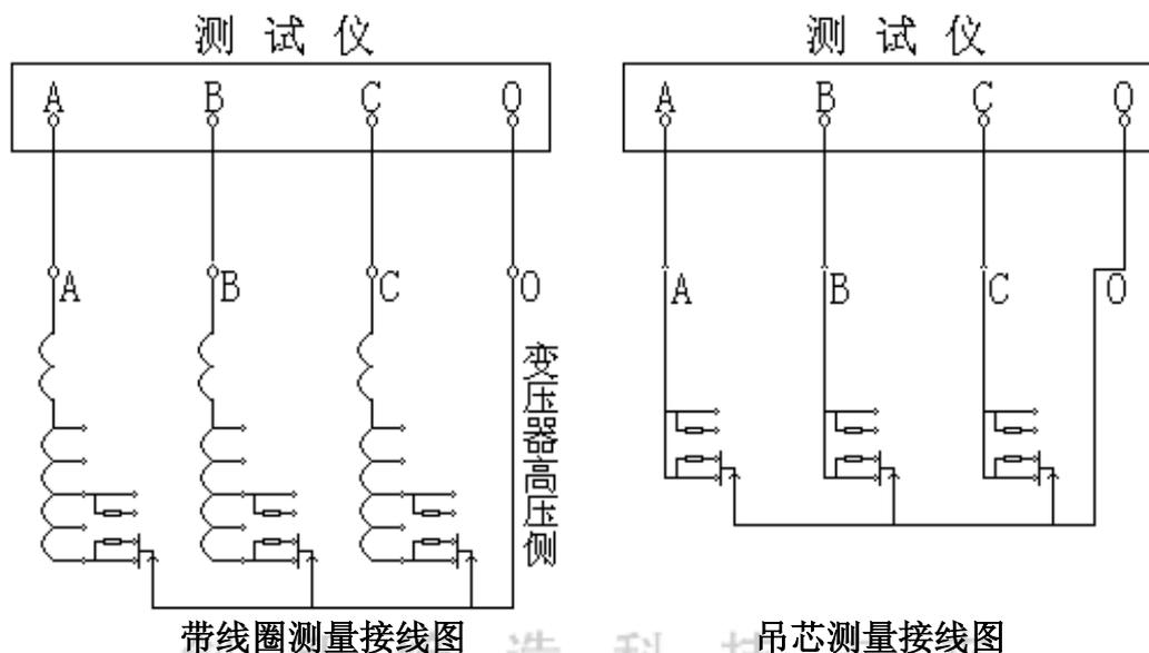
将仪器内附的4根（红、绿、黄、黑）大线夹取出来，用大线夹夹住变压器高压端子的A、B、C和中性点O端，将线的另一接线端子分别插入仪器面板上的A、B、C、O插孔。用小夹子将变压器低压侧的a、b、c、O端子短路接地即可。
