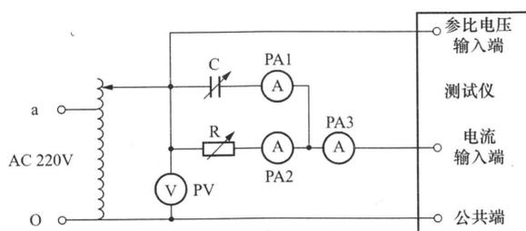
C—可调电容箱；R—可调电阻箱；PV—测量参比电压的交流电压表
